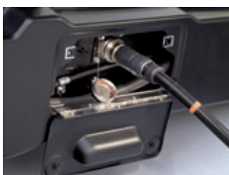
ODU-Ladestecker, angeschlossen an die am Chassis angebrachte Steckdose zum Laden der Batterie am Einbaort
