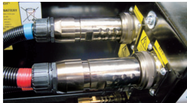
ODU-Hochspannungssteckverbinder zum Anschluss der Batteriekassette an den Elektroantriebsmotor.
